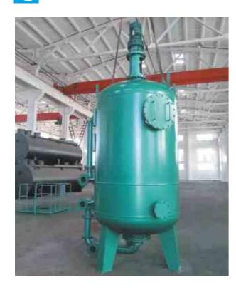
纤维球过滤器适用于处理江、河、湖泊及水库等浊度不大于 100mg/l的地表水的深度净化处理;同样适用于游泳池循环用 水处理,废水生物处理后的直接过滤,更适合水源比较紧张的 缺水地区给水, 使出水水质透明、清洁、卫生。达到国家饮用 水水质标准。
