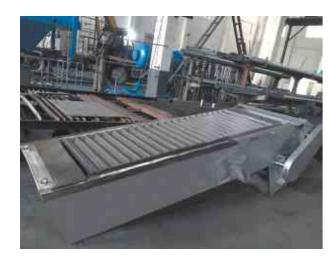
回转式机械格栅(格栅除污机)是一种可以连续自动清除流体中各种形状的杂物,以固液分离为目的装置,它可以作为一种专用设备广泛地应用于城市污水处理、自来水行业、电厂进水口,同时也可以作为纺织、食品加工、造纸、皮革等行业生产工艺中必不可少的专用设备,是目前我国最先进的固液分离设备,回转式机械格栅又称格栅除污机。
