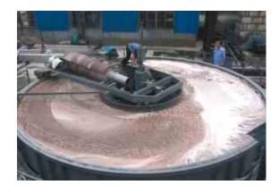
MW-QCF浅层气浮就是通过溶气系统产生的溶气水,经过快速减压释放在水中产生大量微细气泡,若干气泡粘附在水中絮凝好的杂质颗粒表面上,形成整体密度小的悬浮物,通过浮力使其上升至水面而使固液分离的一种净水法。高效浅层气浮装置,是在传统气浮理论的基础上,又成功地运用了"浅层理论"和"零速"原理,通过精心设计,集凝聚、气浮、撇渣、沉淀、刮泥为一体,是一种水质净化处理的高效设备。
