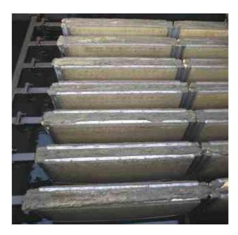
纤维滤布滤池是目前世界上最先进的过滤装置之一,该滤池采 用纤维滤布作为过滤介质,以替代传统的砂滤池,主要应用于 污水厂提标改造、中水回用工程以及其它污水处理工程的过滤 工艺。在污水处理厂提标改造工程中, 结合化学除磷处理措 施,可使出水从一级B提升到一级A标准,满足污水处理厂的 提标改造要求。
