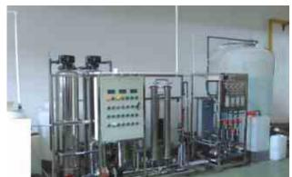
该设备是一种阴、阳离子交换树脂按一定比例分层装填同一交换柱内的离子交换装置。均匀混合的树脂层阳树脂与阴树脂紧密地交错排列,每一对阳树脂与阴树脂颗粒类似于一组复床,故可以把混床视作无数组复床串联运行的离子交换设备。
